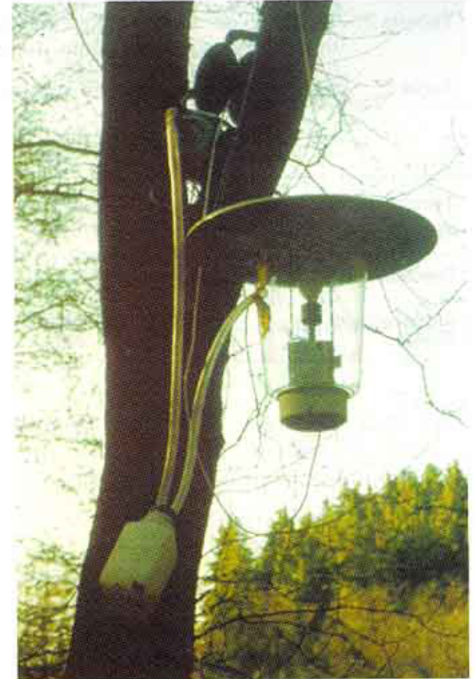
Abb. 2: Lichtfanganlage (mit Ansaugvorrichtung; unten rechts Auffangbehälter mit Fixierflüssigkeit, rechts oben der Sauger; Verbindung mit 1 Zoll breitem Plastikschlauch)
