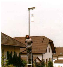
Abb. 4: Einsatz der „Crew“ vom BUND im Ortsgebiet Sulzheim. Unter der Kastenleuchte hängt ein Plastiksektor mit 4 Fangsektoren. Das 10 l Fanggefäß ist von unten angeköpelt.
