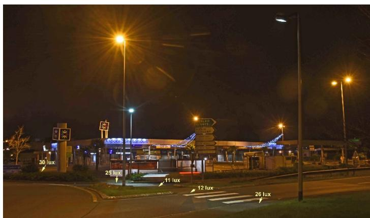
Figure 10 : Rond-Point de la croix Saint-Lambert. Mesures d'éclairage, vers l'écran à gauche et face au parking à droite.
